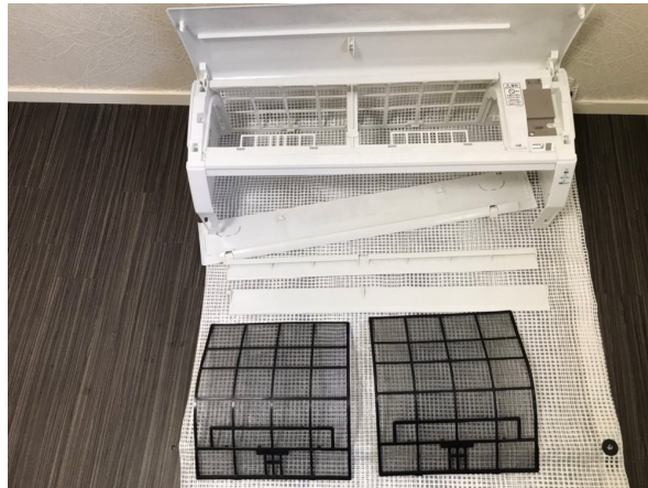
14.エアコンクリーニング
