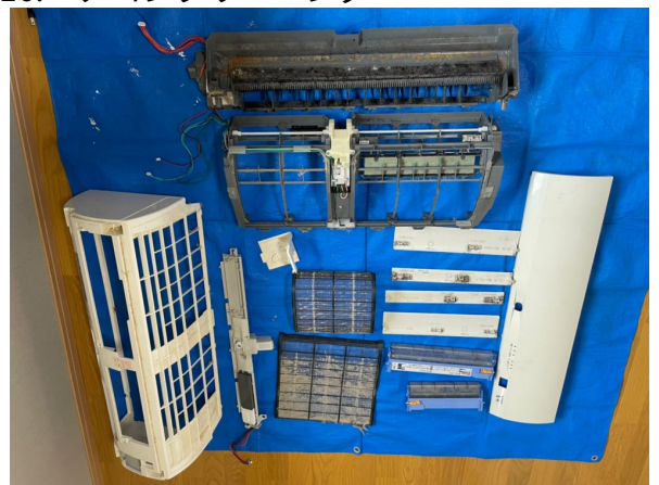
16.エアコンクリーニング
