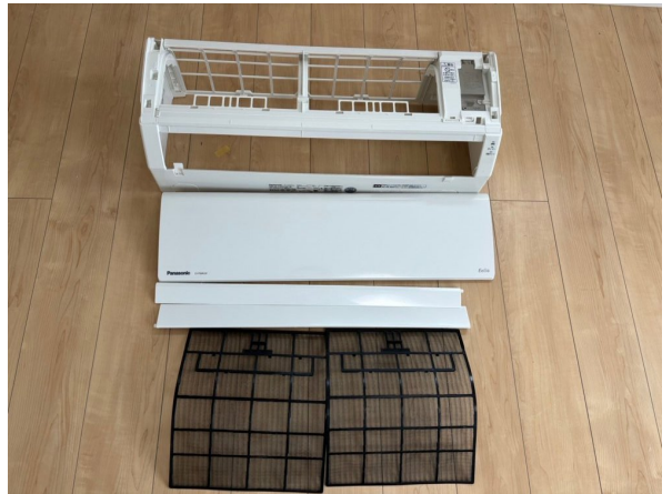
18.エアコンクリーニング
