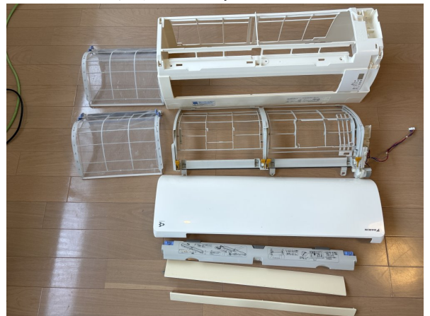
17.エアコンクリーニング
